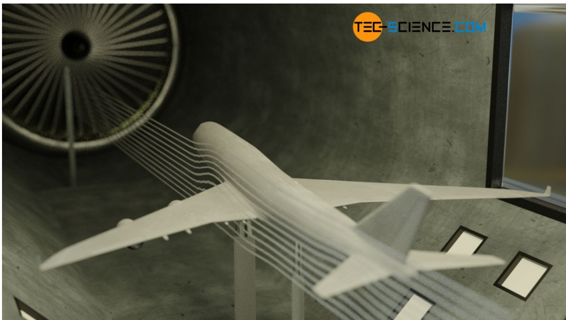
Figura: Modello di aeromobile in una galleria del vento per studiare il flusso attorno all'aeromobile
